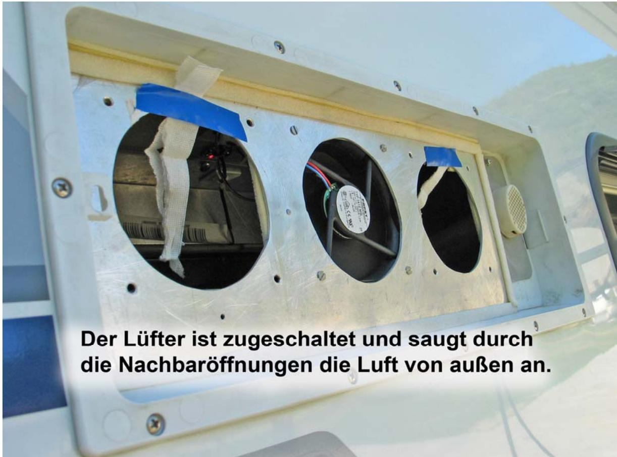
Bei nicht laufenden Lüftern beeinflussten geringe Luftböen die Strömungsrichtung. Das kann sich positiv auf die Kühlung auswirken.
